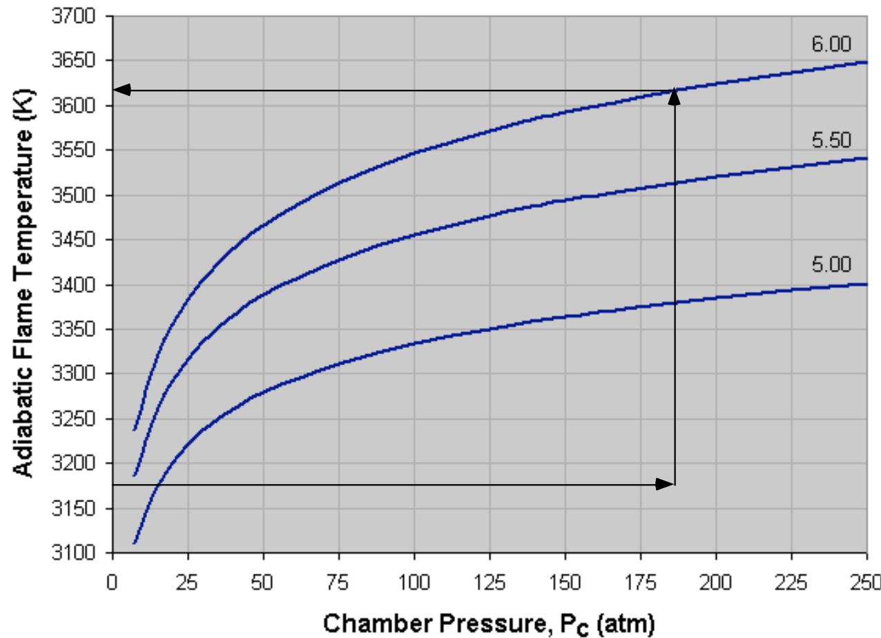
$$T_0 \sim 3615^{\circ}\text{K}$$
